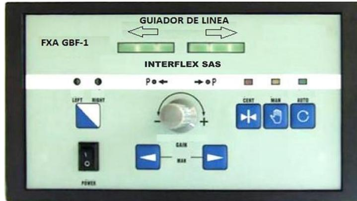
El guiador de banda es un dispositivo que utiliza un sensor para detectar el borde o línea de impresión para mantener la película en la posición correcta a través de un actuador.
