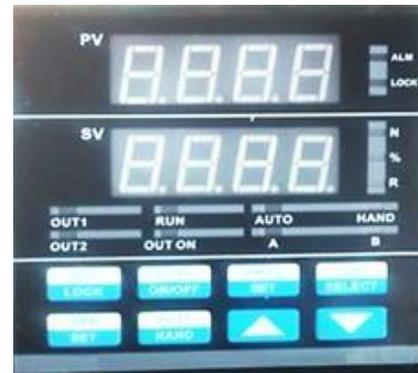
El control de Tensión FXA095 es aplicación diseñada específicamente para controlar con precisión de tensión para bobinado y desbobinado
